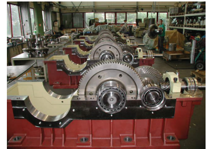
Montage von Hubgetrieben
